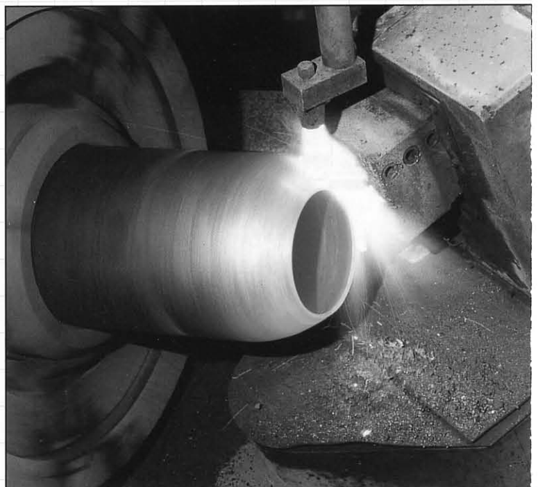
Fig. 5 - L'opération de floutournage permet de fabriquer le fond ou le col de la bouteille comme le potier façonne la terre. (Photo Mannesmann).
